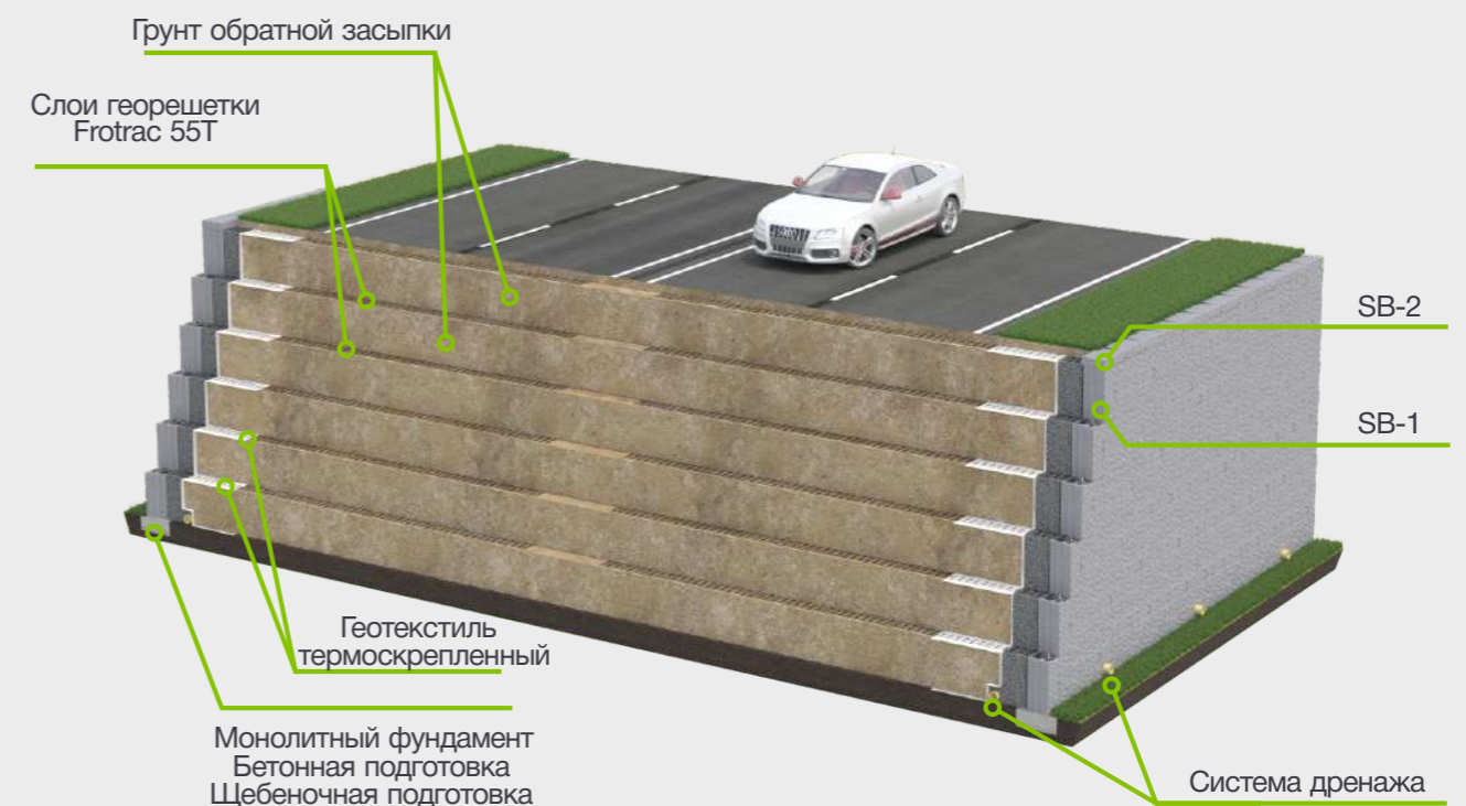
Рис. 4 - Схема насыпи с закреплением подпорными блоками
